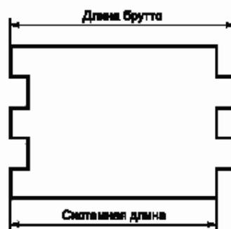
Рисунок А.1 — Размеры изделий с пазогребневым соединением
