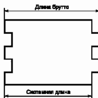
Рисунок А.1 — Размеры изделий с пазогребневым соединением
